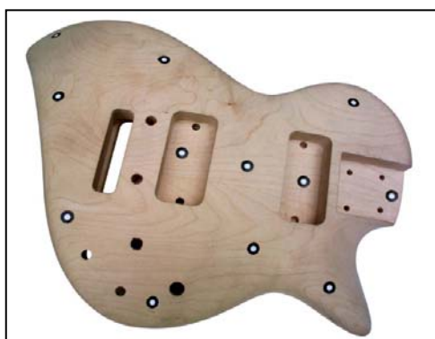
Obr.10 Referenční body přímo na objektu
