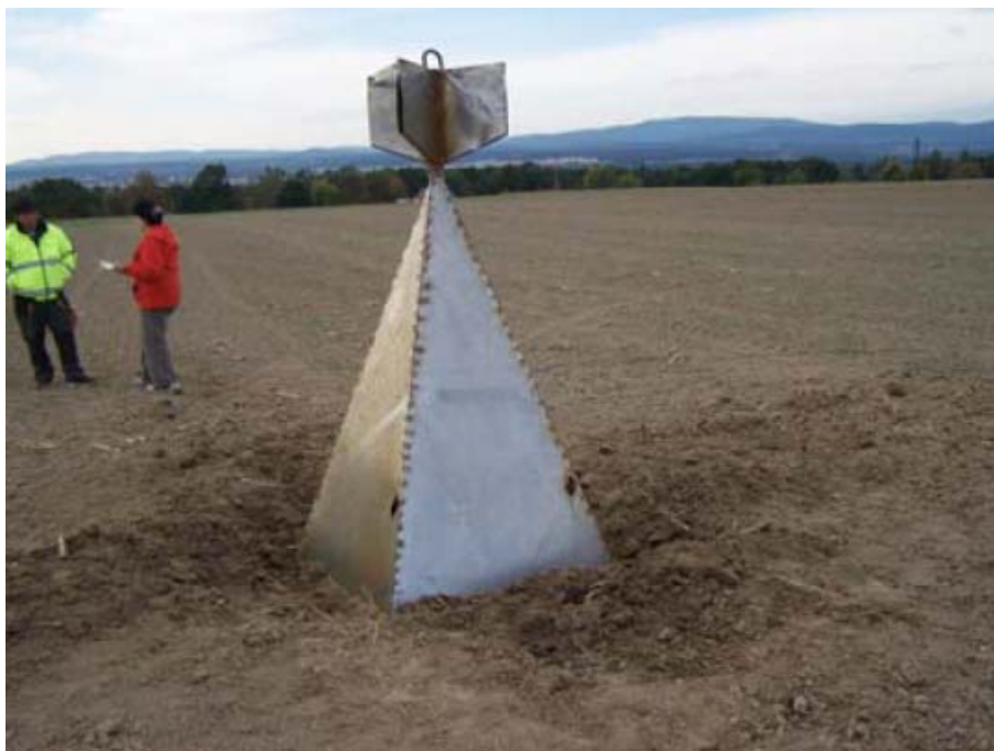
Obr. 5: Osmistěn po dopadu, pádová výška 125m
