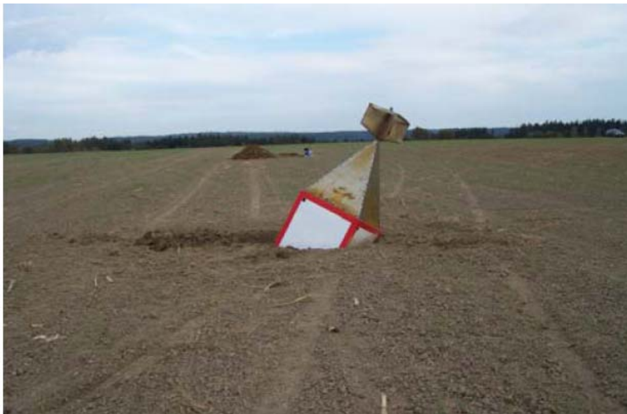
Obr. 3: Krychle po dopadu, pádová výška 125 m
