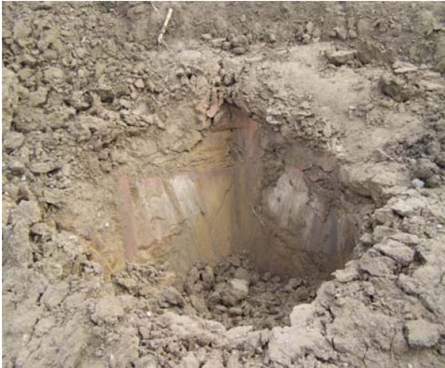
Obr. 7: Deformace povrchu po dopadu krychle, pádová výška 300 m
